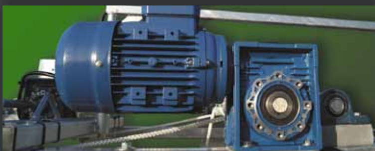
380 volt motoren met wormwielvertraging voorzien van levensduursmering.
