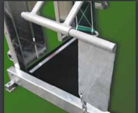
Dit klepje kan onder de klauw van de voorpoot gezet worden, voor extra stevigheid tijdens het bekappen.
