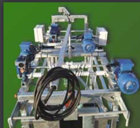
Alle motoren en elektriciteit zijn boven op de box gemonteerd.
