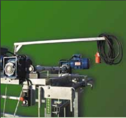
Snoergeleider voor de voedingskabel, deze is draaibaar in de gewenste richting.
