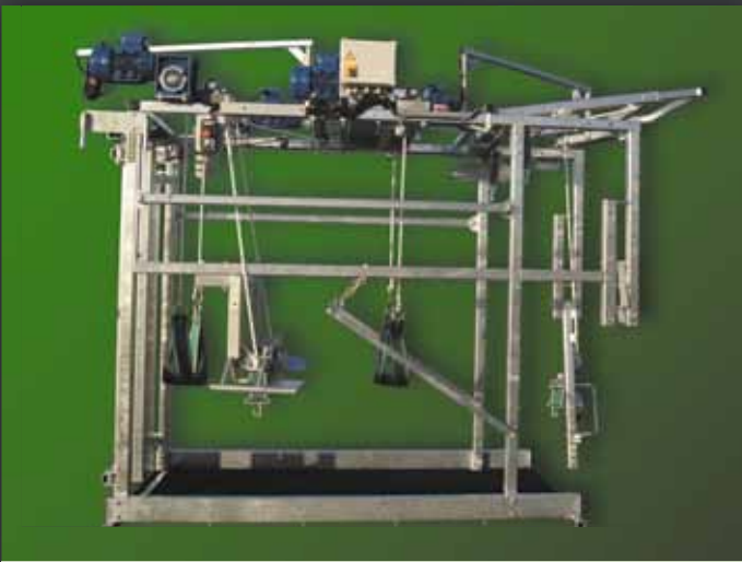
Zijaanzicht box met kontbuis omhoog, en achterpootfixeerinrichting naar beneden.
